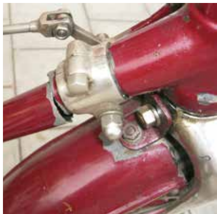
Framebreuk... Metaalmoetheid is niet abnormaal bij een voertuig van bijna 120 jaar oud.
