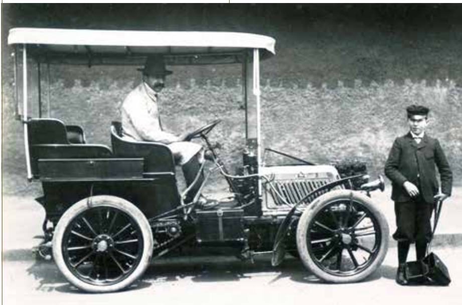
▲ Deze 1901 Déchamps was luchtgekoeld, want er is geen radiator te bespeuren.
