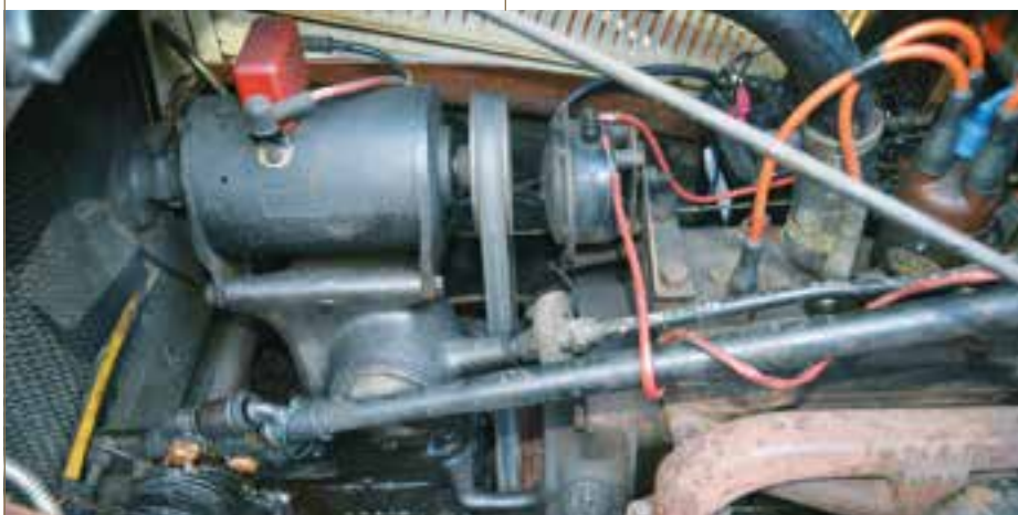
Zicht onder de motorkap. De versnellingsbak zit vooraan, erboven is de dynamo gemonteerd, die ook de ventilator aandrijft
